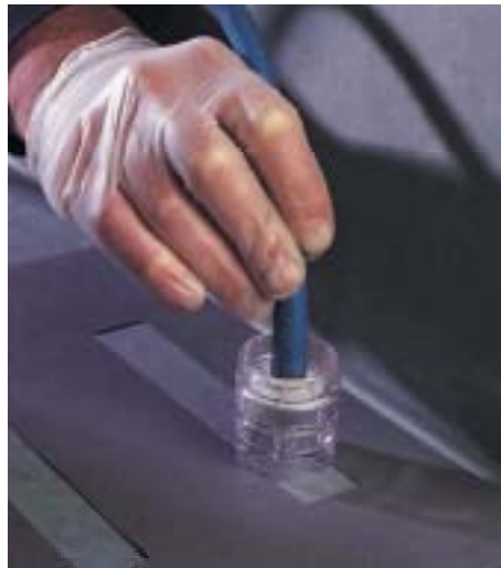
Abb. 4-9: NADCA-Vakuum-Test zur Kontrolle der Reinigungseffizienz
