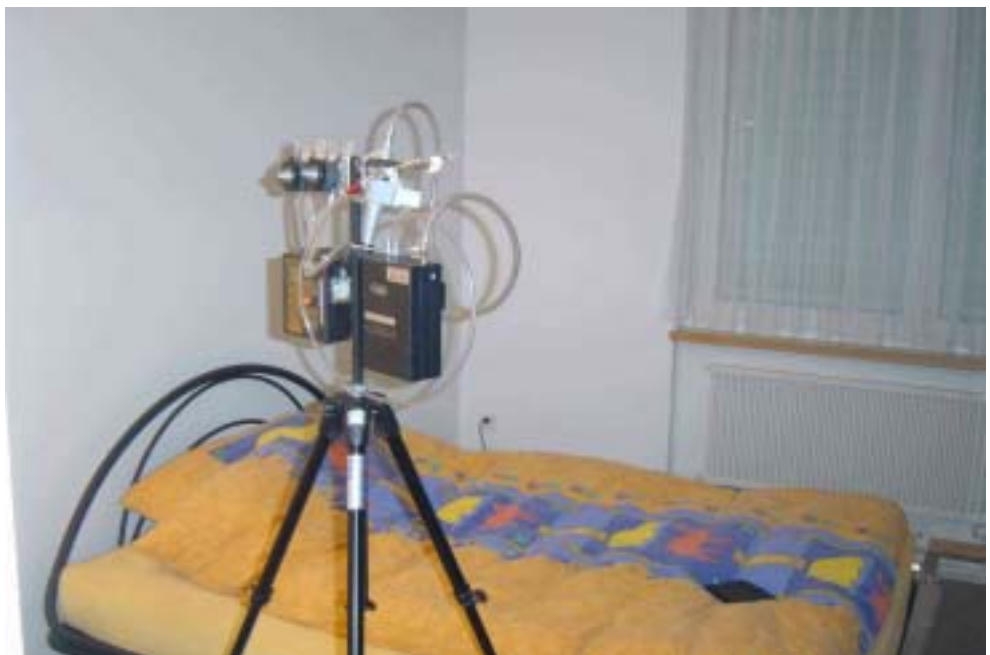
Abb. 5-3: Gebäude A, Messpunkt 4, Messung der Raumkonditionen
