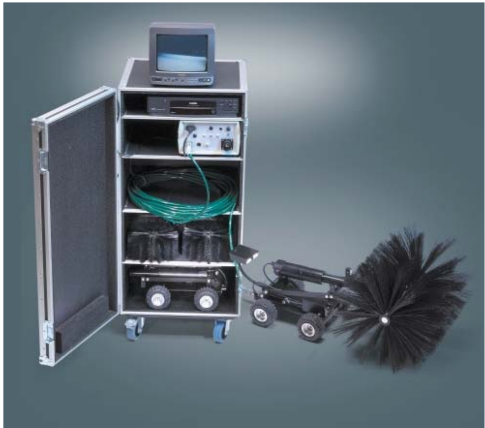
Abb. 4-7: Komplette Ausrüstung für Inspektion und Reinigung der Luftkanäle. Rechts ist ein Reinigungsroboter mit nach vorne gerichteter Bürstenbewegung zu sehen.
