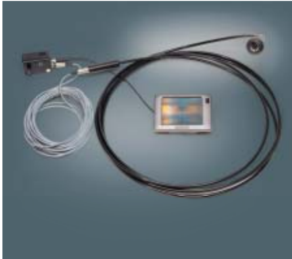
Abb. 4-3: Endoskop für die Aufnahme von runden kleinen Kanälen
